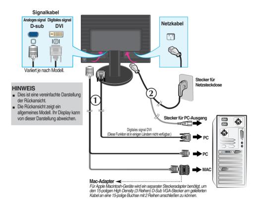
**4.** Drücken Sie auf dem vorderen Bedienfeld die Taste 🔱 , um den Strom einzuschalten. Beim Einschalten des Monitors wird automatisch die Funktion "Automatische Bildeinstellung" ausgeführt. (Nur Analog-Modus)
