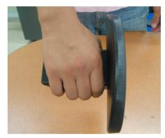
4. Halten Sie die Verriegelungen weiter gedrückt und halten Sie das Ständerteil mit der anderen Hand. Drücken Sie den Ständersockel in Pfeilrichtung heraus.
