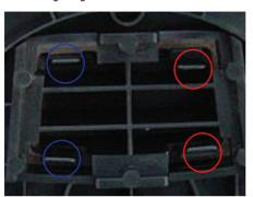
3. Drücken Sie die beiden langen Verriegelungen wie abgebildet
