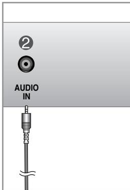
② Zur Verbindung mit der \*LINE OUT-Buchse der PC-Soundkarte.
