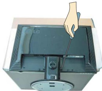
3. Installieren der Halterung für die Wandmontage.
