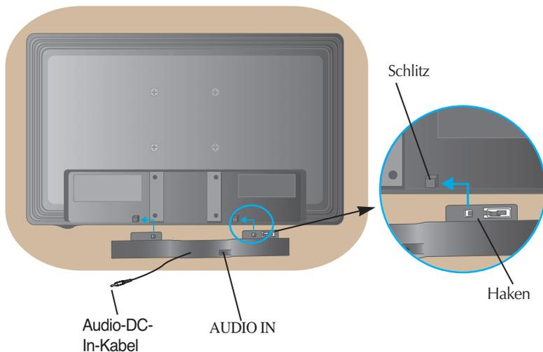
3. Schließen Sie das Audio-DC-In-Kabel nach Aufstellen der Lautsprecher an der Rückseite des Produkts an.
