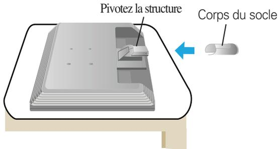
3. Insérez la Base du socle dans le Corps du socle dans la direction indiquée ci-dessous.
