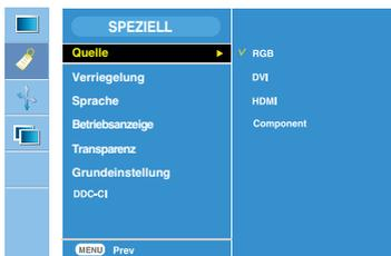
Beim Drücken der Tasten **- +** wird das folgende Eingangssignalfenster eingeblendet. Wählen Sie die gewünschte Signalart mit diesen Tasten aus.
