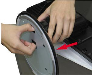
4. Verwenden Sie einen Schraubendreher zum Abbau des Ständers (siehe Abbildung). Anmerkung: Bitte bewahren Sie die 4 Schrauben für den späteren Gebrauch sicher auf.
