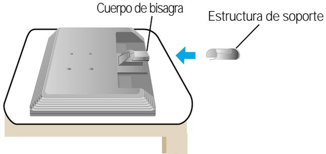
3. Monte la Stand Base (Base del soporte) en Stand Body la (Estructura de soporte) en la dirección correcta. No obstante, el cuerpo del soporte sólo queda fijado con firmeza si se conecta a la base.
