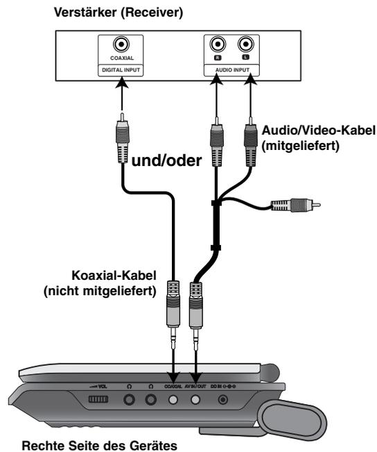
**Mit analogem Zweikanal-Stereo oder Dolby Pro Logic II / Pro Logic ausgerüsteten Verstärker:** Verbinden Sie die AV IN/OUT-Buchsen des DVD-Players über das Audiokabel mit der linken und rechten Eingangsbuchse des Verstärkers, Receivers bzw. der Stereoanlage.
