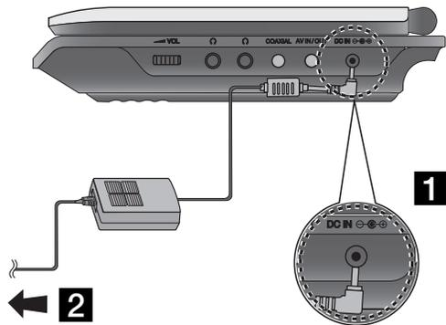
**1** Schließen Sie den Netzadapter an die Buchse DC IN  $\ominus \text{---} \oplus$  am Gerät an.
