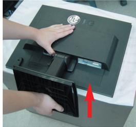
4. Sujete el producto del otro modo que se indica y gire la base del soporte en la dirección de la flecha hasta que escuche un "chasquido".
