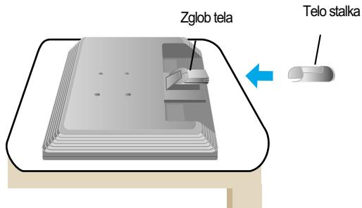
3. Montirajte osnovu stalka (prednja i zadnja strana) u telo stalka u ispravnom pravcu. Međutim, telo stalka biće učvršćeno samo kada je spojeno sa osnovom.
