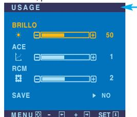
Seleccione el submen **SAVE** mediante el botón SET y guarde el valor **SÍ** mediante los botones -.
