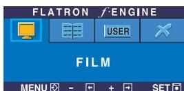
**PELÍCULA** Esta función le permite seleccionar fácilmente la mejor condición de imagen deseada optimizada para el entorno (iluminación ambiente, tipos de imágenes, etc.).
