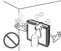
**Bei austretendem brennbaren Gasen vor dem Betrieb des Gerätes das Gas abdrehen und Fenster zur Belüftung öffnen.**
