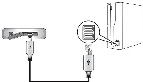
2 Si el dispositivo USB es reconocido con normalidad una vez conectado el cable, el mensaje "USB connected" y la versión del firmware aparecerán en la LCD.
