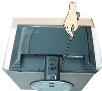
3. Montavimo ant sienos plokštelės montavimas.
