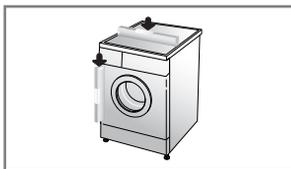
1. La nivelación correcta de una lavadora impide el ruido y la vibración excesivos. Instale el aparato sobre una superficie de suelo sólida y nivelada, preferiblemente en la esquina de una habitación.
