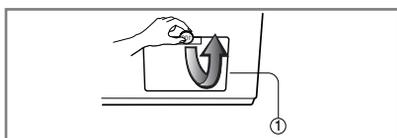
1. Abra el tapón de la cubierta inferior (1) utilizando una moneda. Gire el tapón de drenaje (2) para sacar la manguera.
