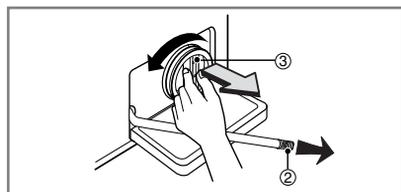
2. Desconecte el tapón de drenaje (2) dejando que el agua fluya hacia fuera. En este momento utilice un recipiente para impedir que el agua caiga al suelo. Si ya no sale agua, gire el filtro de la desagüe (3) a la izquierda hasta abrirlo totalmente.
