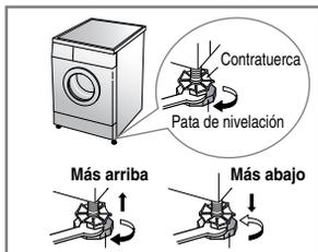
2. Si el suelo no está nivelado, ajuste los pies de nivelación según sea necesario (**no introduzca trozos de madera, etc. debajo de los pies**). Asegúrese de que los cuatro pies son estables y descansan sobre el suelo y, a continuación, compruebe que el electrodoméstico está perfectamente nivelado (utilice un nivel de burbuja de aire)
