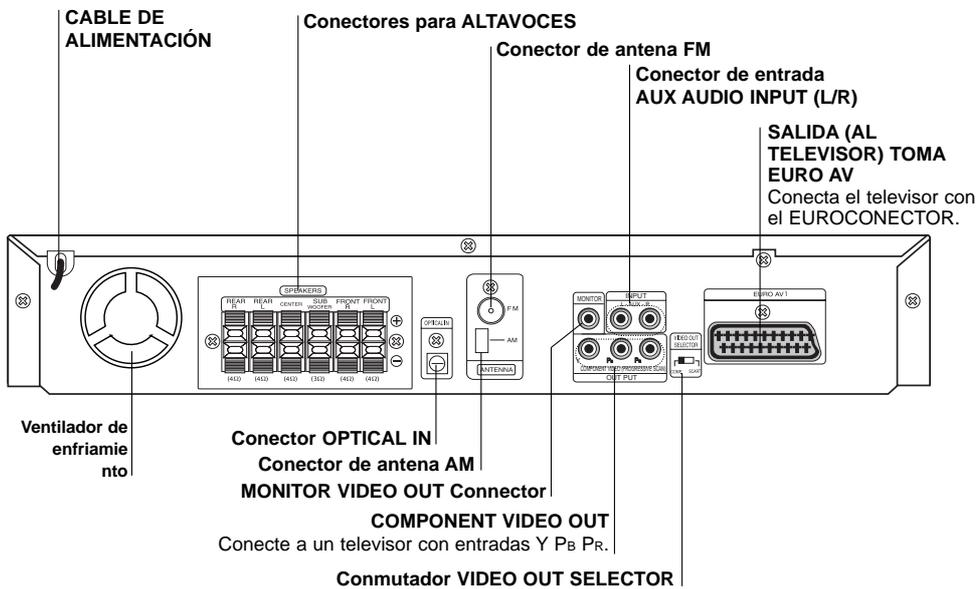
⚠ **No toque las clavijas internas de los jacks en el panel posterior. La descarga electrostática puede causar daño permanente a la unidad.**
