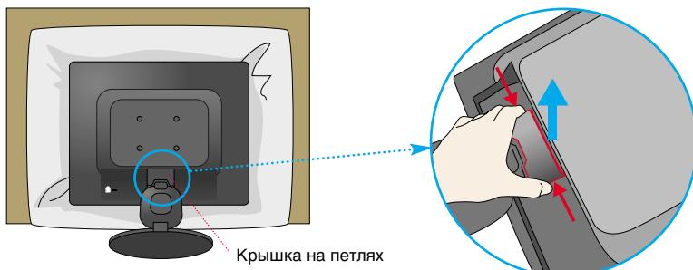
2. Отделите основание подставки с помощью отвертки.
