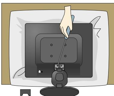
3. Установка пластины для настенного крепления.
