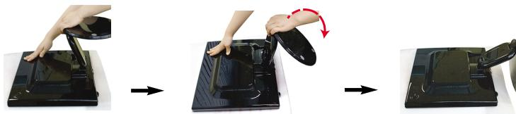
4. Поставьте монитор вертикально и отрегулируйте угол наклона, как требуется. Изменяя угол наклона подставки, держите верхнюю часть корпуса монитора обеими руками.
