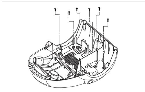
2) 如图拆下手柄堵头
