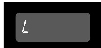
Zrušenie funkcie **DETSKEJ POISTKY** vykonáte stlačením a podržaním tlačidla **STOP/CLEAR (ZASTAVIŤ/VYNULOVAT)** až „L“ zmizne. Ako potvrdenie po uvoľnení budete počuť zvukový signál.
