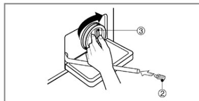
4. Après le nettoyage, faire tourner le filtre de la pompe (③) dans le sens des aiguilles d'une montre et insérer le bouchon de purge (②) pour le remettre en place. Fermer le capot du couvercle inférieur.
