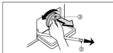
2. Retirer le bouchon de purge (①), laisser l'eau s'écouler. Utiliser un récipient pour empêcher l'eau de se répandre sur le sol. Lorsque l'eau ne s'écoule plus, ouvrir le filtre de la pompe (②) en le faisant tourner vers la gauche.
