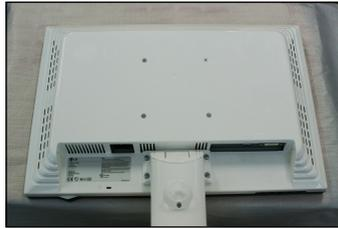
2. Separe el soporte utilizando un destornillador como aparece en la figura.
