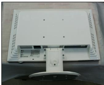
3. Presione el pestillo hacia adentro, Extraiga la base de soporte de la estructura de soporte.
