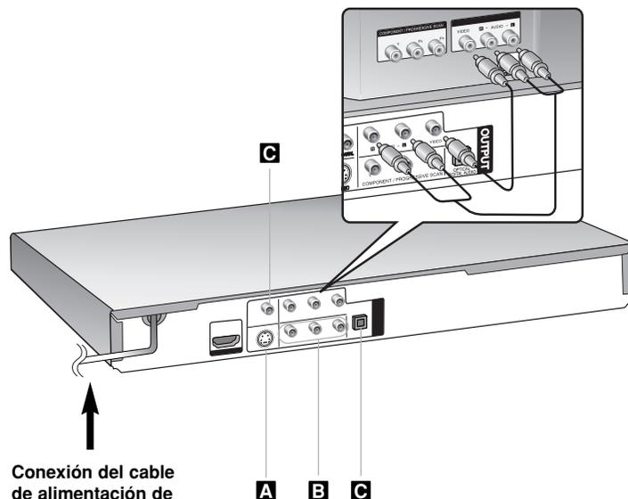
Conexión del cable de alimentación de CA a la toma de corriente.
