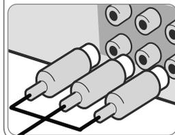
Conecte las tomas COMPONENT / PROGRESSIVE SCAN de la unidad a las tomas de entrada correspondientes de su televisor con el cable Y PB PR.
