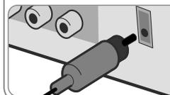
Conecte la toma de entrada ÓPTICA a la toma de salida óptica de su TV (o dispositivo digital, etc.).
