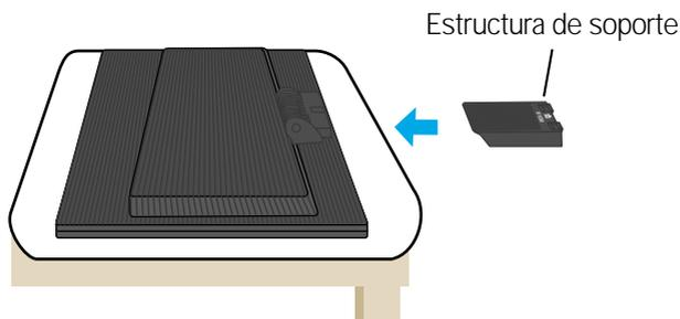
3. Monte la Stand Base (Base del soporte) en Stand Body la (Estructura de soporte) en la dirección correcta
