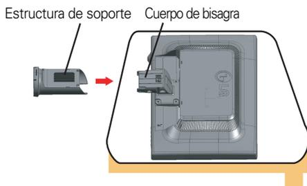
3. Monte la Stand Base (Base del soporte) en Stand Body la (Estructura de soporte) en la dirección correcta.
