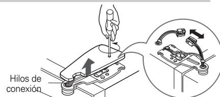
2) Suelte la protección girando en sentido horario (①) y suelte la bisagra superior elevándola (②).
