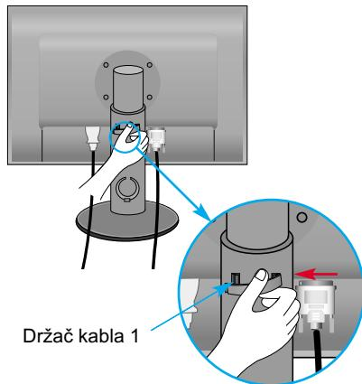
2. Molimo stavite kabl za napajanje i signalni kabl u držaču kabla 1.
