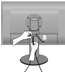
3. Molimo stavite kabl za napajanje i signalni kabl u držacu kabla 2.
