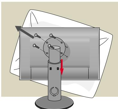
2. Uklonite zavrtanj pomoću odvijača i povucite stalak u pravcu strelice. Onda su delovi stalka i glava odvojeni.
