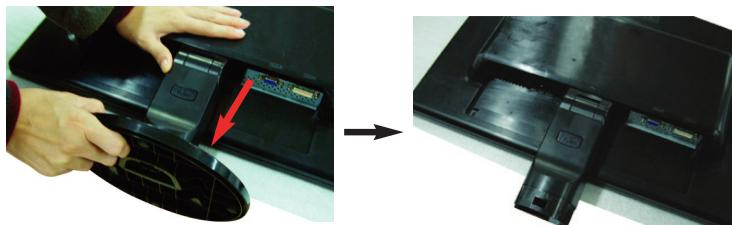
5. Нажав кнопку PUSH, снимите стойку с корпуса монитора.
