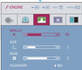
Seleccione el submenú **GUARDAR** utilizando el **botón AUTO/SET** y guarde el valor **SI** utilizando los botones **▼**, **▲**.
