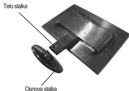
4. Ključ baze namestite vertikalno pod pravim uglom.
