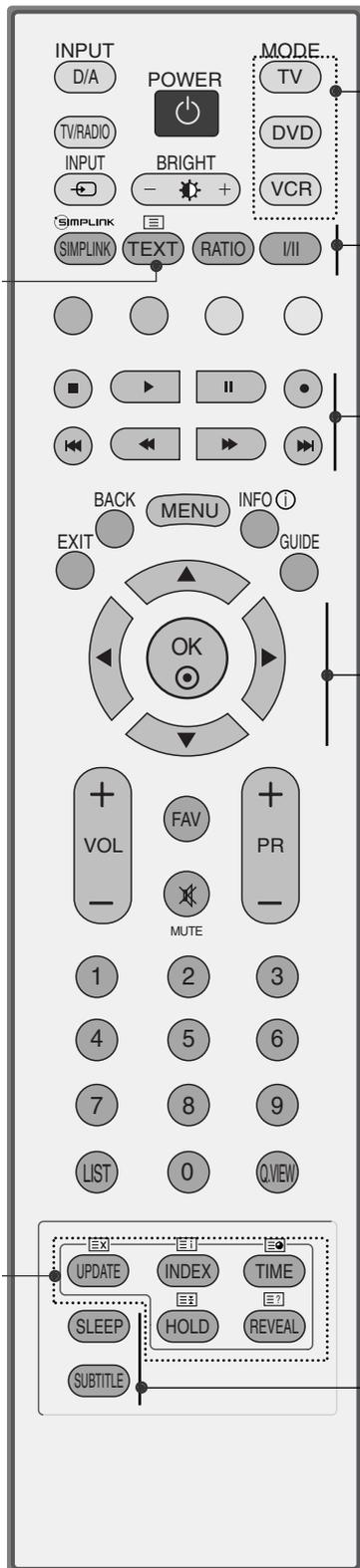
**MODE** Permet de sélectionner les modes de fonctionnement à distance.
