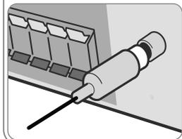
FM - подключение антенны диапазона FM. Наилучшее качество радиоприема обеспечивается, когда два свободных конца антенны располагаются на одной горизонтальной линии.
