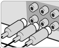
Соедините гнезда выходного компонентного видеосигнала ресивера COMPONENT VIDEO (PROGRESSIVE SCAN) OUTPUT с соответствующими гнездами телевизора кабелем Y PB PR.
