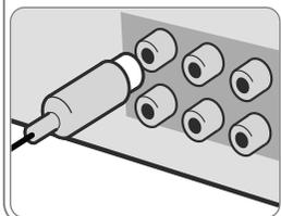
Соедините гнездо VIDEO OUTPUT (MONITOR) этого устройства с соответствующими входными гнездами телевизора кабелем видеосигнала.
