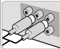
Гнезда входного аудиосигнала ресивера имеют цветовую маркировку (красный цвет – правый канал, белый цвет – левый канал). Если ваш телевизор оснащен только одним гнездом входного аудиосигнала (монофонический звук), подключите к нему левый канал ресивера (белое гнездо).
