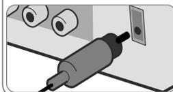
Подключите OPTICAL IN (оптический вход) к оптическому выходу телевизора (или цифрового устройства и т.д.)
