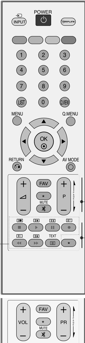
**1** **TELETEXT-Tasten** Diese Tasten werden für den Teletext verwendet. Weitere Informationen dazu erhalten Sie im Abschnitt "Videotext".
