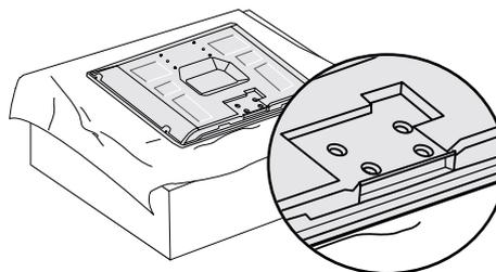
Befestigen Sie die SCHUTZBLENDE (PROTECTION COVER) am Fernsehgerät, bis ein Klickgeräusch zu hören ist.
