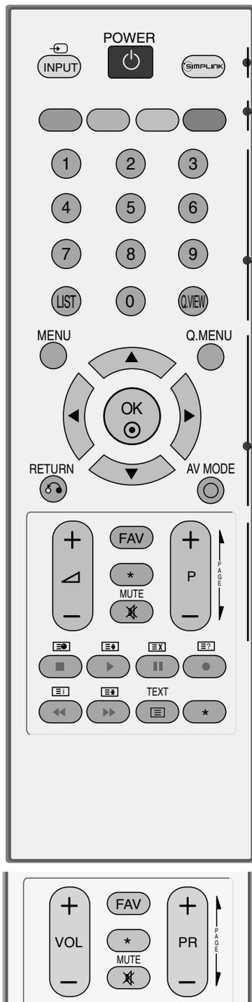
**POWER** Schaltet das Gerät aus dem Standby Ein oder in den Standby Aus.
