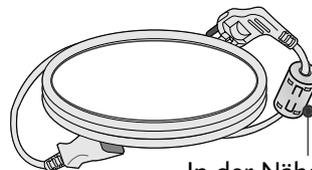
In der Nähe des Netzsteckers montieren.
