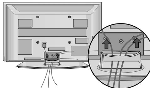
\* Drücken Sie beim Modell 42PG1\*\*\* auf die Mitte der **KABELHALTERUNG(CABLE MANAGEMENT CLIP)** und heben Sie die Halterung an.
