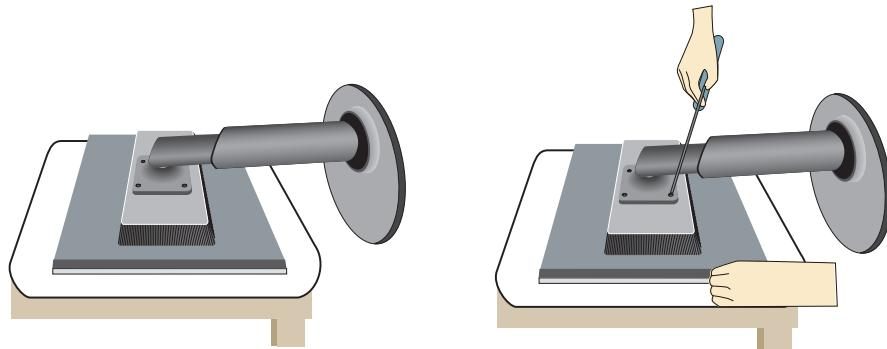
3. Postavite ploču za zidni nosač.
