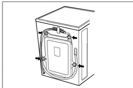
1.避免運送途中發生內部損壞，機組由4根運送螺栓固定。洗衣機運轉前，先行拆除附帶橡膠塞的螺栓。
