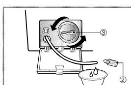
3.清除泵過濾器（③）內所有殘留物。清理完成後，將泵過濾器（③）順時針旋轉，再將排水塞（②）插回原來位置，關上下蓋帽。
