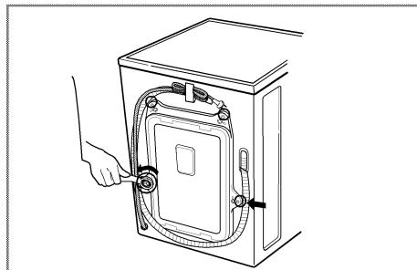
2.使用隨附的扳手將螺栓拆除。
