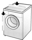
正確調整洗衣機的水平狀態，可避免產生過多的噪音和振動。
