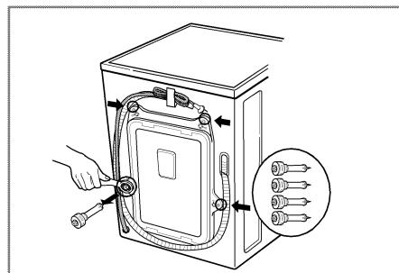
3.輕旋橡膠塞將4根螺栓連同塞子一併拿出來。將4根螺栓和扳手收好，以備將來之需。
