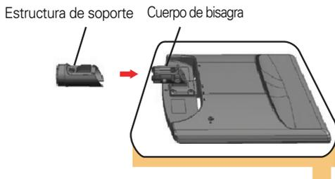
3. Monte la Stand Base (Base del soporte) en Stand Body la (Estructura de soporte) en la dirección correcta.
