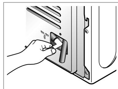
4. Sluit de afvoerslang aan op de kit.
