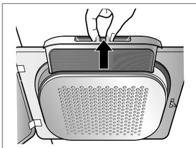
3. Nettoyez le filtre en utilisant un aspirateur ou en le rinçant sous le robinet.
