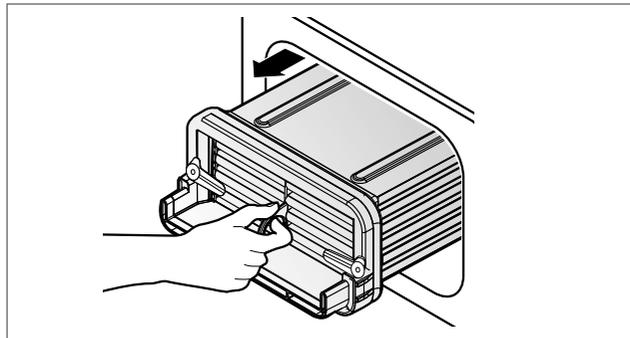
5. Reinig de condensor volledig onder de waterkraan door het water er door te laten lopen.
