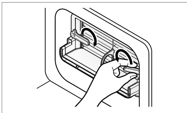
4. Trek de condensor eruit door een vinger in de opening te steken op de voorkant van de condensor. (Gebruik vooral geen kracht)
