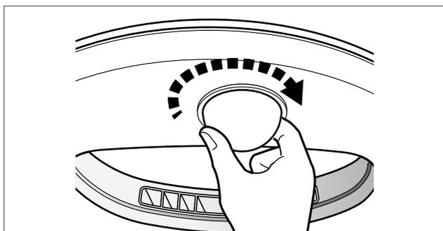
3. Séparez le cache de l'ampoule du logement de la douille.
