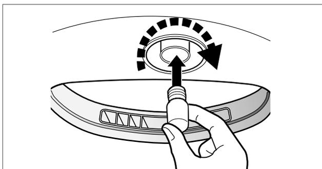
6. Le cache ampoule à la main, tournez l'ampoule dans le sens des aiguilles d'une montre en exerçant une certaine pression, jusqu'à ce que vous entendiez un dé clic.
