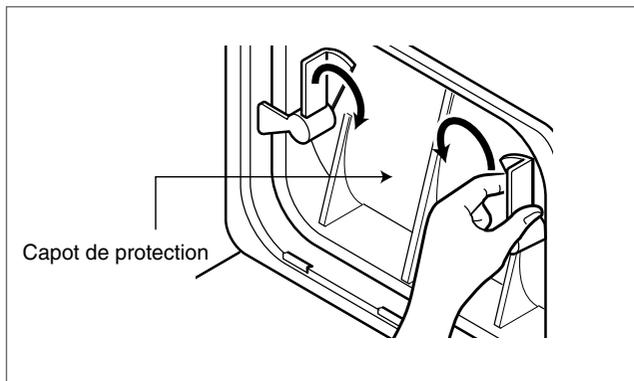
3. Déverrouillez les deux leviers de blocage en les tournant l'un vers l'autre.
