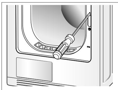
3. Retirez le verrou de la porte et insérez-le à l'emplacement du couvercle de protection de la porte.
