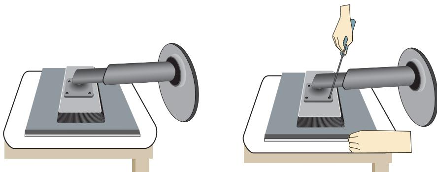
3. Nainstalujte desky držáku na zeď.
