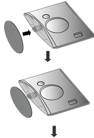
**3** Ziehen Sie die Schraube rechts herum fest, um den Monitor am Standfußsockel zu befestigen.
