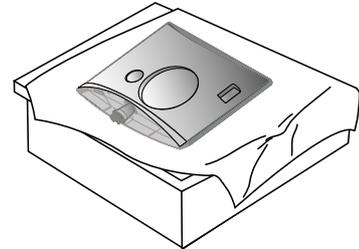
**2** Setzen Sie den Standfußsockel in das Gerät ein.
