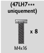
Boulons pour l'assemblage du socle (Voir page 13)
