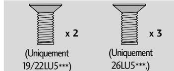
Boulons pour l'assemblage du socle (Voir page 12)
