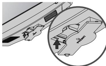
Insérez le couvercle de protection dans le téléviseur jusqu'au « clic ».
