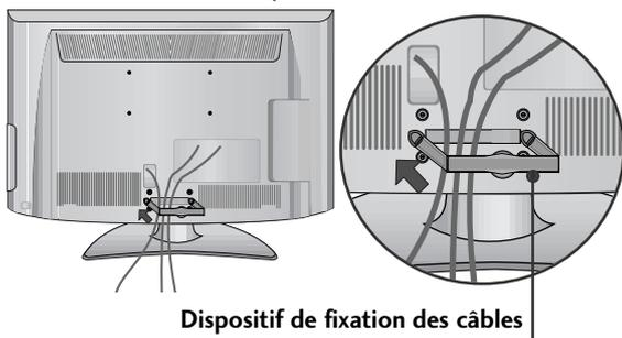
Dispositif de fixation des câbles
