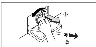
2. Fjern afløbsproppen, så vandet kan komme ud. Brug en beholder, for at hindre vandet i at flyde ud på gulvet. Når vandet er holdt op med at løbe ud, åbner man pumpefilteret ved at vride det mod venstre.
