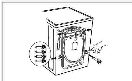
1. Laitteessa olevat neljä erityistä ruuvia kiinnitetään siirtämisen ajaksi, jotta laite ei vahingoittuisi. Ennen kuin pesukonetta käytetään siiron jälkeen, ruuvit ja kumiset tapit tulee irrotaa.
