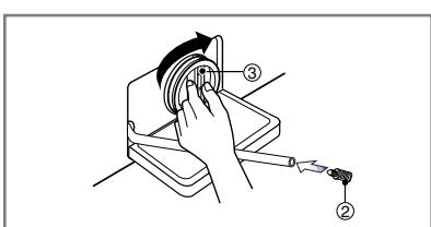
4. Käännä tämän jälkeen pumpun suodatinta myötäpäivään ja aseta poistoletkun korkki paikalleen. Sulje alavaipan suojuks.
