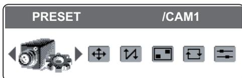
3. Pulse el botón **[Cam OSD]** para mostrar el menú de configuración de la cámara.
