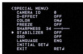
La función de estabilización de imagen minimiza la aparición de imágenes movidas debido a vibraciones de baja frecuencia.
