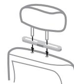
Napomena: Ako ne možete da instalirate postolje nosača na naslonu zbog debljine vašeg noslona na sedištu, produžite nosač popuštajući šrafove, pa onda instalirajte kako treba.
