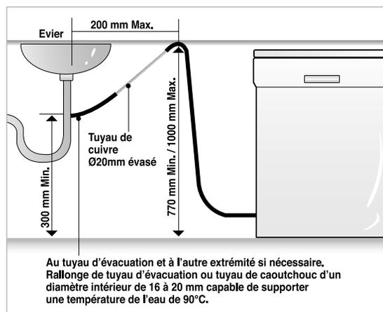
Au tuyau d'évacuation et à l'autre extrémité si nécessaire, Rallonge de tuyau d'évacuation ou tuyau de caoutchouc d'un diamètre intérieur de 16 à 20 mm capable de supporter une température de l'eau de 90°C.
