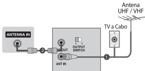
2. Feito isto, conecte o cabo RF na conexão **ANT. OUT** (gravador) e na **ANTENNA IN** (TV).
