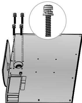
2. Encaixe o suporte pedestal à base, fixando corretamente os parafusos fornecidos conforme figura.
