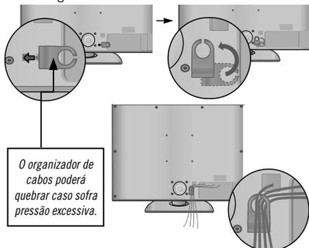
2. Gire o organizador de cabos como indicado e coloque os cabos dentro da fenda do organizador de cabos.
