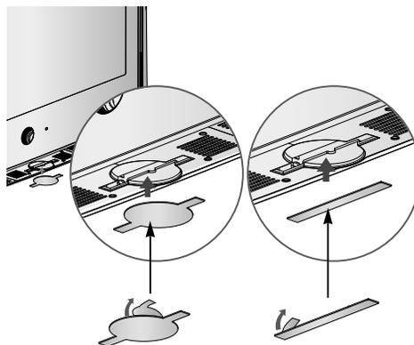
\* Antes de colocar a tampa protetora, remova a fita adesiva indicada na imagem acima.
