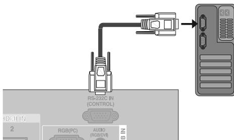
1. Conecte a porta serial do equipamento de controle à entrada RS-232C no painel traseiro da TV (cabo não fornecido).
