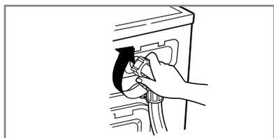
4. Resserrer le tuyau d'arrivée d'eau.
