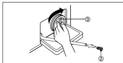
4. Après le nettoyage, faire tourner le filtre de la pompe (③) dans le sens des aiguilles d'une montre et insérer le bouchon de purge (②) pour le remettre en place. Fermer le capot.
