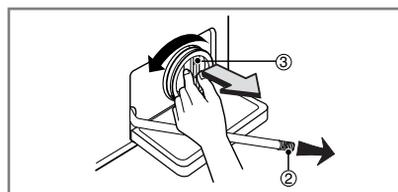
2. Retirer le bouchon de purge (②), laisser l'eau s'écouler. Utiliser un récipient pour empêcher l'eau de se répandre sur le sol. Lorsque l'eau ne s'écoule plus, dévisser le filtre de la pompe (③) en le faisant tourner vers la gauche.
