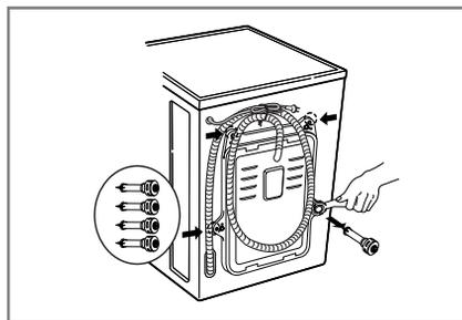
3. Enlever les 4 vis ainsi que les rondelles en caoutchouc en tordant légèrement la rondelle. Garder les 4 vis et la clé pour une utilisation future.
