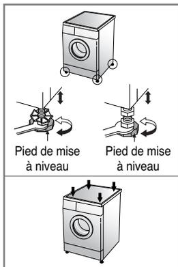
2. Si le sol est inégal, régler les pieds de mise à niveau (ne pas insérer de cales de bois, etc ... sous les pieds). S'assurer que les quatre pieds sont stables et reposent sur le sol. Vérifier ensuite que l'appareil est parfaitement à niveau (utiliser un niveau à bulle d'air).
