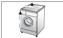
1. Pour réduire les vibrations et les bruits excessifs, installer la machine sur un sol stable et à niveau, de préférence dans un coin de la pièce.
