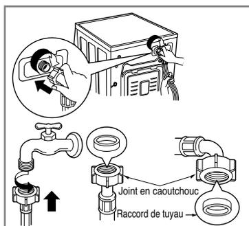
▶ La pression d'alimentation d'eau doit être comprise entre 30kPa et 1000kPa (0,3~10kgf/cm<sup>2</sup>).
