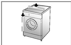
1. Pour réduire les vibrations et les bruits excessifs, installer la machine sur un sol stable et à niveau, de préférence dans un coin de la pièce.
