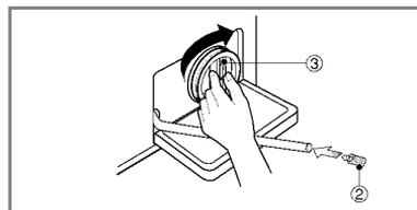
4. Après le nettoyage, faire tourner le filtre de la pompe (3) dans le sens des aiguilles d'une montre et insérer le bouchon de purge (2) pour le remettre en place. Fermer le capot.
