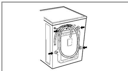
1. Les 4 vis spéciales sont serrées pour prévenir tous dommages internes pendant le transport. Avant de faire fonctionner la machine à laver, enlever les vis ainsi que les rondelles en caoutchouc.
