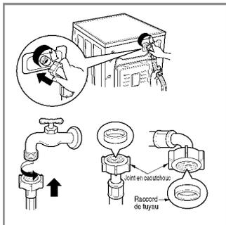
▶ La pression d'alimentation d'eau doit être comprise entre 30kPa et 1000kPa (0,3~10kgf/cm<sup>2</sup>).
