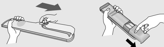
■ Abra la tapa del compartimiento de las baterías en la parte posterior e instale las baterías con la polaridad correcta.
