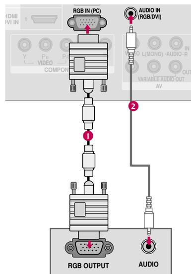
CONEXIONES DE EQUIPO EXTERNO
