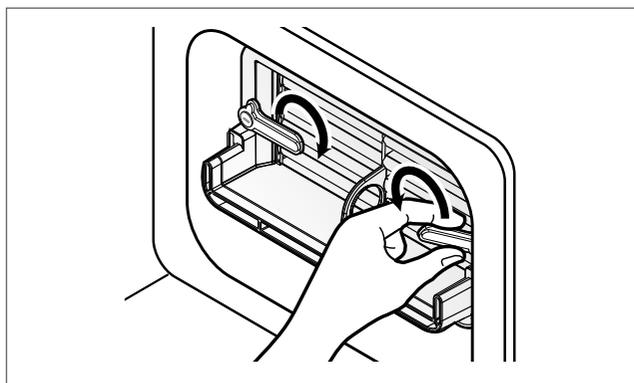
4. Sortez le condenseur en insérant un doigt dans un trou sur le bas de la façade du condenseur. (Ne forcez pas sur le condenseur.)
