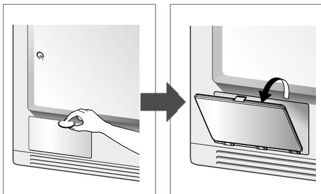
2. Ouvrez le capot de protection en tournant les leviers de blocage.
