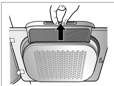
3. Nettoyez le filtre en utilisant un aspirateur ou en le rinçant sous l'eau du robinet.
