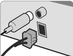
FM - Conecte la antena FM. La recepción será óptima cuando los dos extremos sueltos de la antena estén en línea recta y horizontal.
