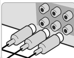
Conecte las tomas COMPONENT VIDEO (PROGRESSIVE SCAN) OUTPUT de la unidad a las tomas de entrada correspondientes de su televisor con el cable Y PB PR.
