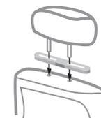
Hinweis: Falls die Montageleiste für die Kopfstütze nicht angebracht werden kann, da die Rohrstärke der Kopfstütze zu groß ist, erweitern Sie die Montageleiste durch Lösen der Schrauben.
