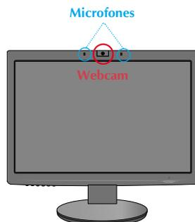
1. Para utilizar a função webcam, ligue o cabo USB e instale os programas no CD de software da câmara web.
